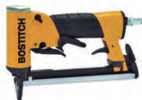
GRAPADORA GAMA ALTA AUTOMÁTICA EMPLEA GRAPA 80 DE 4 A 16mm. NEUMÁTICA, PRESIÓN: 5 a 7 ATM. CÓDIGO: 1247.284
