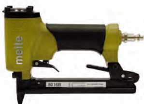
GRAPADORA GAMA ECONÓMICA MODELO ECO 8016B EMPLEA GRAPA 80 DE 7,5mm. NEUMÁTICA, PRESIÓN: 4 a 7 ATM. CÓDIGO: 372.38
